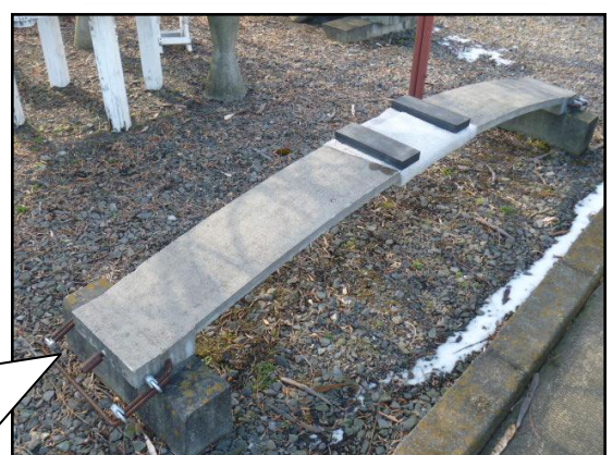
図 f プレストレストコンクリート梁の体重計
