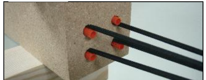
図 d PC鋼材の定着
