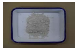
写真 - 10 乾燥スラッジ
