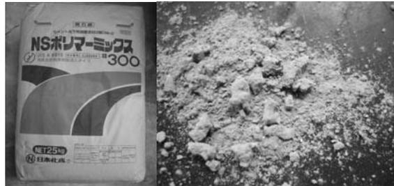
写真-1 セメント (商品名: NS ポリマーミックス#300 (再乳化形粉末樹脂混入タイプ))
