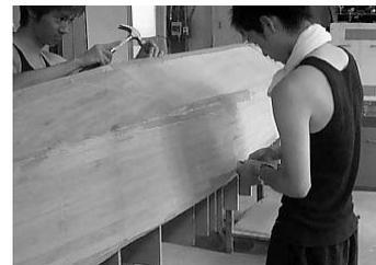
写真-5 型枠にベニヤ板を貼り重ねる
