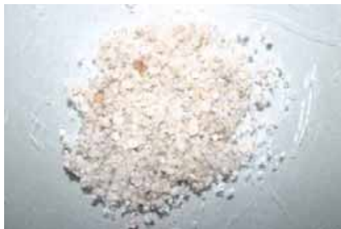
図 船体の軽量骨材として使用したパーライト
