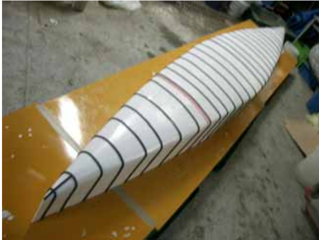
写真-11 型枠完成 (厚さ管理用ゴム貼付け終了)
