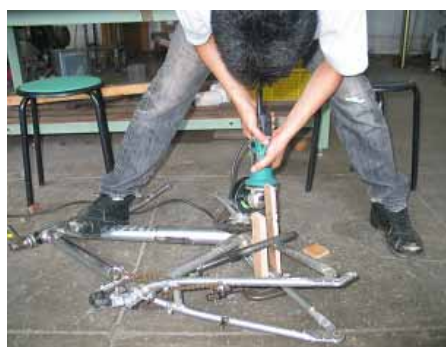
写真- 自転車の加工の様子(躯体を切断中)
