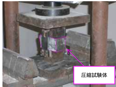
写真-2-2 圧縮試験の様子
