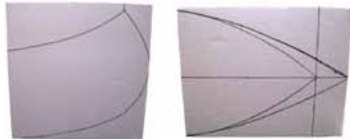
写真-3 発泡スチロール浮力体の罫書き
