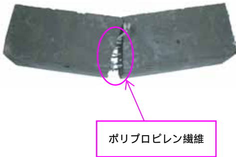
写真-2-1 曲げ試験後のモルタルバー
