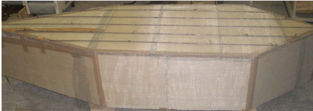
写真-1 補強材の配置状況
