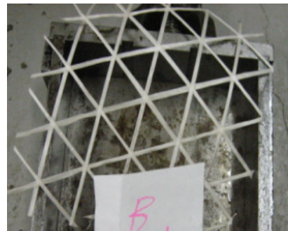
図-2 ビニロン繊維のラス補強材
