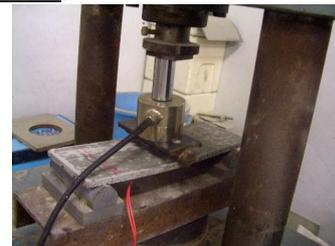
写真-4 モデル試験体の曲げ試験
