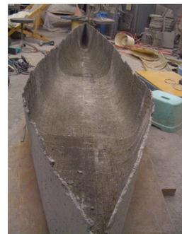
写真-12 脱枠直後の艇 (7.5mmの薄肉ハル)
