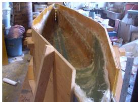
写真-5 FRP実験艇の製作状況
