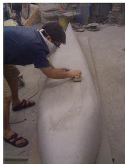
写真-11 サンドペーパーによる艇形の削り出し
