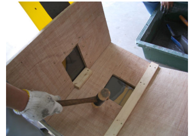
模擬型枠への流し込みによる流動確認
