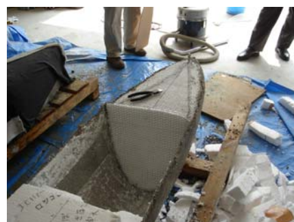
写真-7 船尾部の残した型枠
